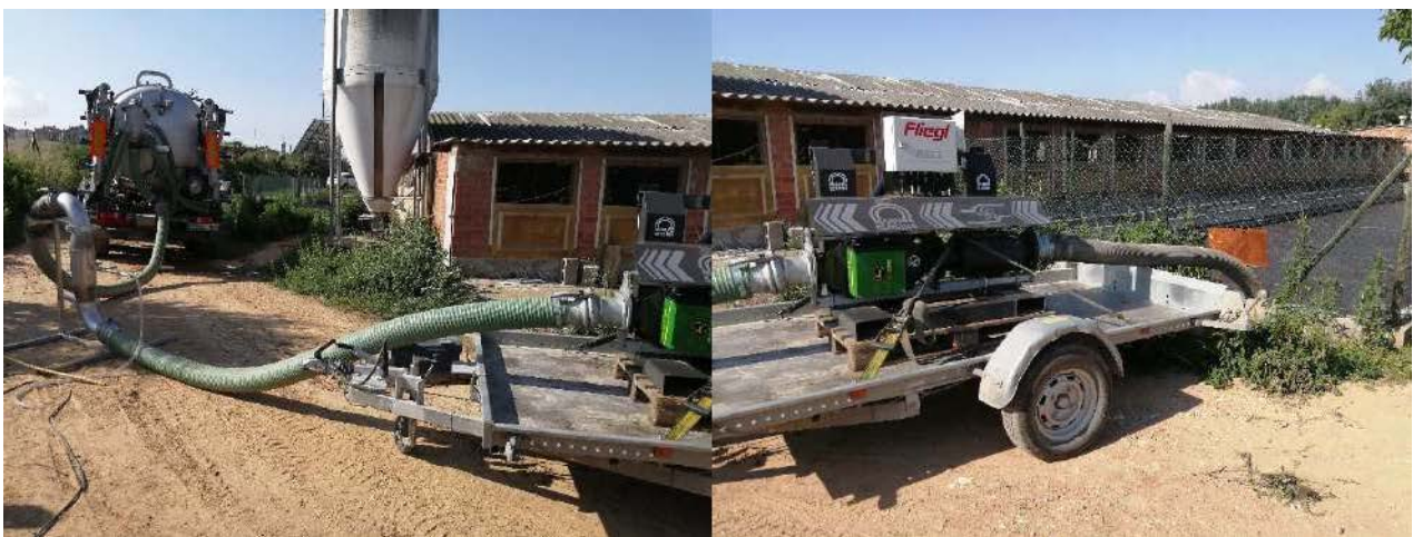
Figura 1. Foto de l'equip de presa de mostres connectat a la cisterna i al NIR (esquerra) i de l'equip estacionari (dreta)
