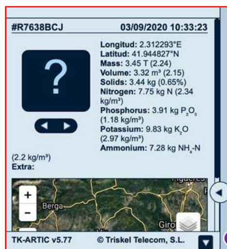
Figura 3. Interfície gràfica de la plataforma online de Triskel Telecom, on s'hi pot veure que entre els detalls de la càrrega de purí d'un camió cisterna, s'hi inclouen les dades extretes de la lectura de l'estació de mesura NIR.
